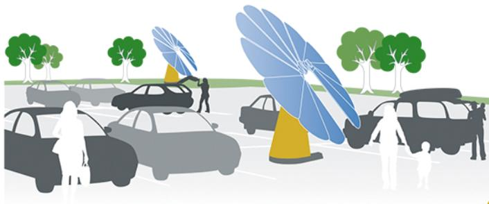
Grazie al suo ingombro relativamente ridotto, POP-e si può integrare in qualsiasi parcheggio esistente. L'installazione viene scelta in base al terreno, tramite base in calcestruzzo o viti per terreno.
